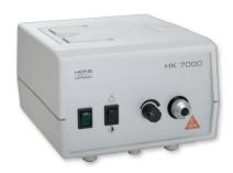
Фиброоптический источник света НК 7000 оснащен специальной долговечной галогенной лампой мощностью 150 Вт. Если для выполнения конкретной задачи требуется большая интенсивность света, можно использовать переключатель повышения мощности, который увеличит интенсивность освещения на 40%. Подходит для всех систем HEINE с фиброоптическим освещением. Размеры: ширина 177 мм, высота 125 мм, глубина 217 мм. Масса 3690 г.
